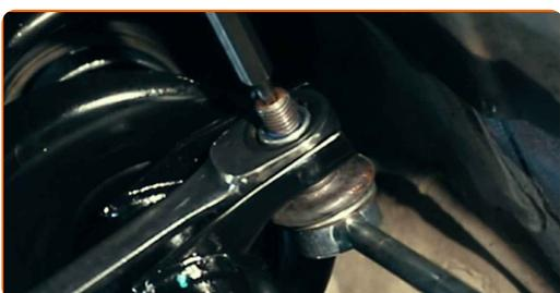
**12** Serra gli elementi di fissaggio che collegano il tirante della barra stabilizzatrice al puntone dell'ammortizzatore. Utilizza una chiave a bussola N°19. Usa una chiave dinamometrica. Serralo fino allo coppia di torsione di 65 Nm.
