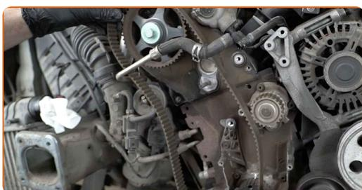
**104** Pulire gli elementi di fissaggio della pompa dell'acqua. Usa una spazzola metallica. Usa un detergente spray multiuso.
