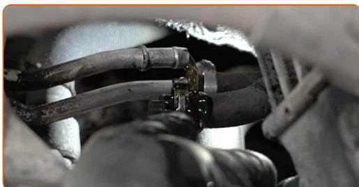
**57** Chiudere con dei tappi i tubi della linea di raffreddamento del fluido del cambio automatico.
