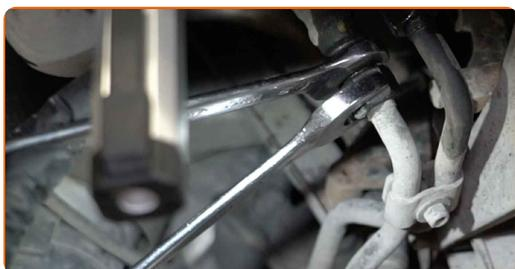
**53** Staccare il tubo della linea di raffreddamento del fluido del cambio automatico.
