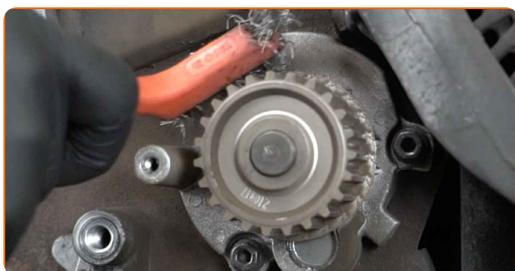
**105** Svitare i dispositivi di fissaggio della pompa dell'acqua. Utilizza una chiave a bussola N°10. Usa una chiave a cricchetto.
