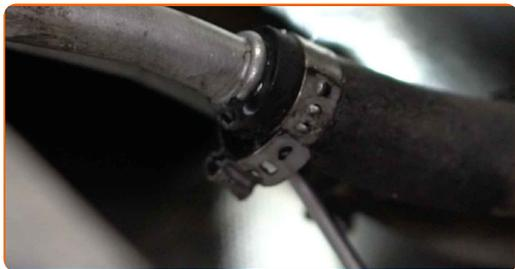
**56** Togliere i tubi della linea di raffreddamento del fluido del cambio automatico.
