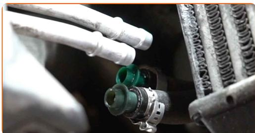
**58** Pulire i tubi della linea di raffreddamento del fluido del cambio automatico. Usa un detergente spray multiuso.
