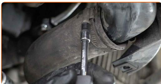
**162** Pulire i tubi della linea di raffreddamento del fluido del cambio automatico. Usa un detergente spray multiuso.
