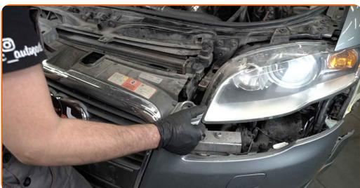
**205** Avvita gli elementi di fissaggio superiori del paraurti. Usa la chiave Torx T 27. Utilizza una chiave a bussola N°10. Usa una chiave a cricchetto.
