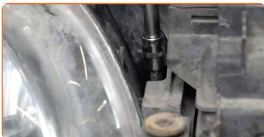
**196** Stringere gli elementi di fissaggio del faro. Usa la chiave Torx T 27. Usa una chiave dinamometrica. Rispettare la coppia di serraggio prescritta.
