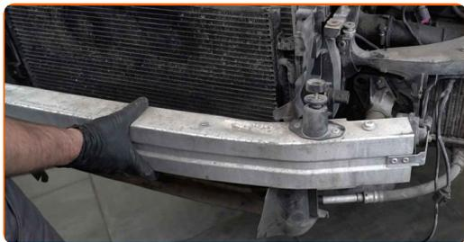
**179** Avvitare gli elementi di fissaggio della barra di rinforzo del cofano. Utilizza una chiave a bussola N°13. Usa una chiave a cricchetto.
