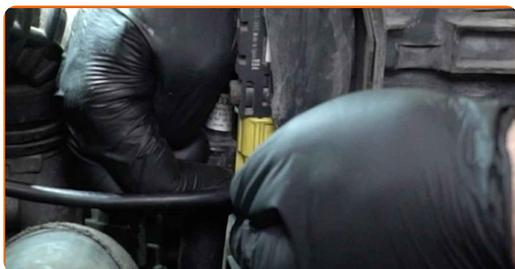
**169** Fissa il collare di fissaggio al tubo di aspirazione. Utilizza una chiave a bussola N°7. Usa una chiave a cricchetto.
