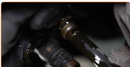
**54** Pulire il tubo della linea di raffreddamento del fluido del cambio automatico. Usa una spazzola metallica. Usa un detergente spray multiuso.
