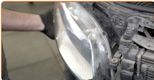
**195** Avvita gli elementi di fissaggio del fanale. Usa la chiave Torx T 27. Usa una chiave a cricchetto.
