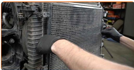
**149** Stringere gli elementi di fissaggio del radiatore dell'aria condizionata. Usa la chiave Torx T 27. Usa una chiave dinamometrica. Serralo fino allo coppia di torsione di 13 Nm.
