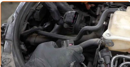
**64** Staccare la clip del tubo di raffreddamento superiore. Usa delle pinze a becchi lunghi.
