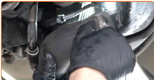
**161** Fissa il collare di fissaggio al tubo di aspirazione. Utilizza una chiave a bussola N°7. Usa una chiave a cricchetto.
