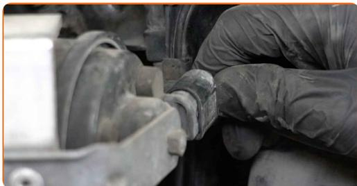
**189** Attaccare i cavi del sensore di temperatura del fluido di raffreddamento.
