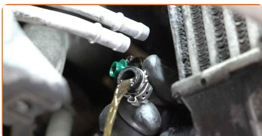
**157** Attaccare i tubi del servosterzo idraulico.
