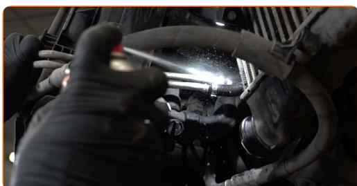
**55** Staccare i morsetti dei tubi della linea di raffreddamento del fluido del cambio automatico. Usa un giravite piatto.
