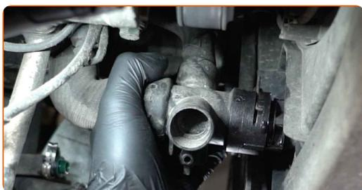
**152** Attaccare la clip del tubo di raffreddamento inferiore.
