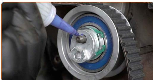
**116** Avvitare il dispositivo di fissaggio del rullo tenditore della cinghia di distribuzione. Utilizza una chiave a bussola N°13. Usa una chiave a cricchetto.
