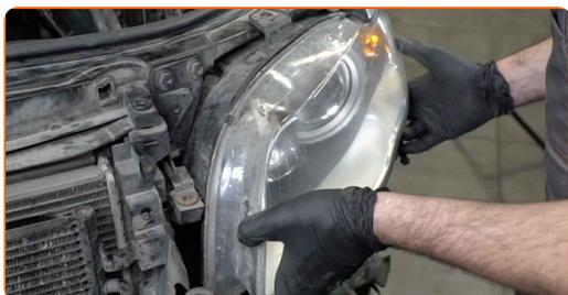
**192** Avvita gli elementi di fissaggio del fanale. Usa la chiave Torx T 27. Usa una chiave a cricchetto.
