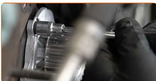
**112** Stringere i dispositivi di fissaggio della pompa dell'acqua. Utilizza una chiave a bussola N°10. Usa una chiave dinamometrica. Serralo fino allo coppia di torsione di 15 Nm.
