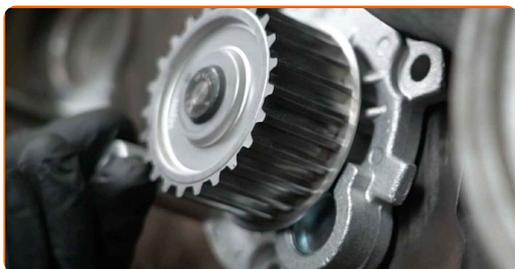
**111** Avvitare gli elementi di fissaggio della pompa dell'acqua. Utilizza una chiave a bussola N°10. Usa una chiave a cricchetto.
