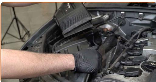
**61** Staccare il connettore delle ventole di raffreddamento del motore.
