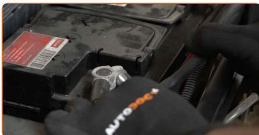
**4** Rimuovi i terminali della batteria.
