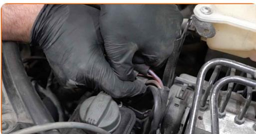
**63** Staccare il connettore delle ventole di raffreddamento del motore.
