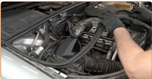
**67** Svitare gli elementi di fissaggio del radiatore dell'aria condizionata. Usa la chiave Torx T 27. Usa una chiave a cricchetto.
