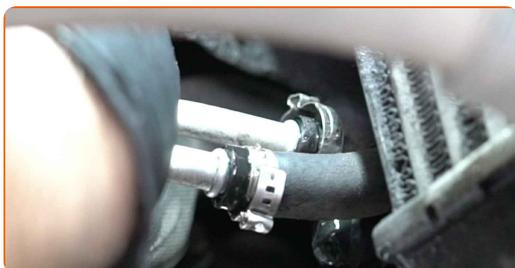
**158** Avvitare gli elementi di fissaggio dei tubi del servosterzo idraulico. Usa la chiave Torx T 20. Usa la chiave Torx T 27. Usa una chiave a cricchetto.
