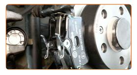
34 Installare la pinza del freno.
