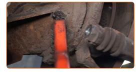
Svitare gli elementi di fissaggio del supporto della pinza del freno. Usa una chiave HEX N.H8. Usa una chiave a cricchetto.
