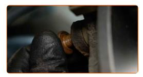
Serrare gli elementi di fissaggio del supporto della pinza del freno. Usa una chiave HEX N.H8. Usa una chiave dinamometrica. Serralo fino allo coppia di torsione di 65 Nm.
