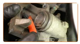
Premere il pistone della pinza del freno. Usa un arretratore per pistoncini freni a disco.
