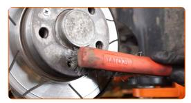
Svitare gli elementi di fissaggio del disco del freno. Usa un cacciavite a percussione. Usa un martello.
