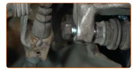
Serra gli elementi di fissaggio della pinza del freno. Utilizza una chiave a bussola N°13. Usa una chiave dinamometrica. Serralo fino allo coppia di torsione di 35 Nm.
