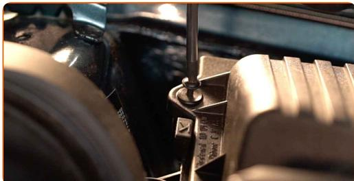
**4** Scollega il collare di fissaggio del tubo di aspirazione. Usa le pinze per pompa ad acqua.
