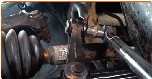
Sostituzione: biellette barra stabilizzatrice - VW Golf IV Van (1J1). AUTODOC raccomanda:
