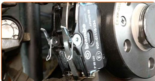
**44** Installare la pinza del freno.
