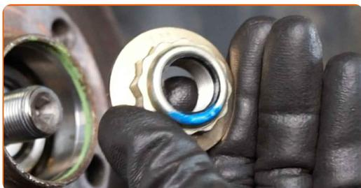
**25** Rimuovere il mozzo insieme al cuscinetto, in quanto realizzati come assemblaggio. Usa un estrattore universale a tre bracci.
