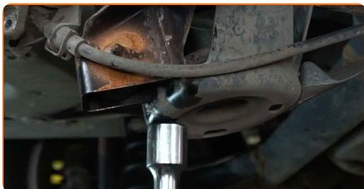
**23** Svitare l'elemento di fissaggio del mozzo della ruota. Usa la chiave a bussola 12 punte n.30. Usa un giramaschi.
