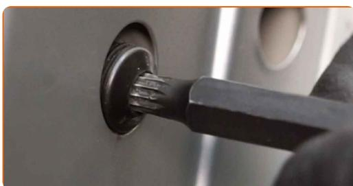
**52** Stringere gli elementi di fissaggio della serratura dello sportello. Usa la chiave XZN n.8. Usa una chiave dinamometrica. Serralo fino allo coppia di torsione di 20 Nm.
