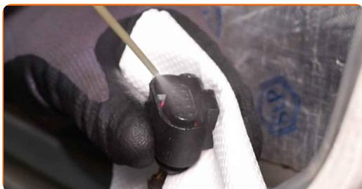
**40** Collegare il connettore della serratura dello sportello.
