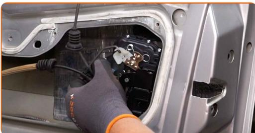
Sostituzione: serratura porta - VW Golf IV Hatchback (1J1). Gli esperti di AUTODOC raccomandano:
