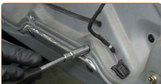
**21** Svitare l'elemento di fissaggio della maniglia esterna dello sportello. Usa la chiave Torx T20. Usa una chiave a cricchetto.
