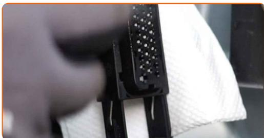
**44** Fissare il connettore dell'alzacristalli elettrico.
