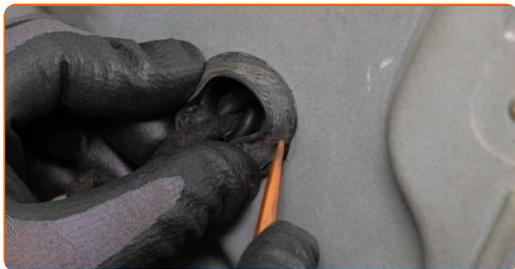
**20** Svitare gli elementi di fissaggio del pannello della portiera. Utilizza una chiave a bussola N°10. Usa una chiave a cricchetto.
