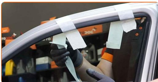
**56** Abbassare il vetro del finestrino e installarlo nella sua sede di montaggio nel meccanismo alzacristalli.
