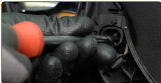
**4** Staccare il pannello interno della portiera. Usa un attrezzo di plastica per la rimozione finiture auto.
