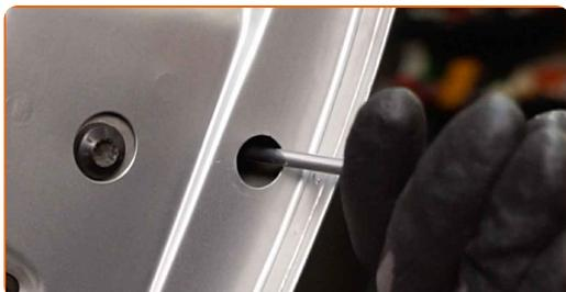
**22** Rimuovere il coperchio dall'elemento di fissaggio della maniglia esterna dello sportello. Usa un attrezzo di plastica per la rimozione finiture auto.
