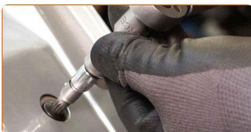
**53** Stringere gli elementi di fissaggio del pannello della portiera. Utilizza una chiave a bussola N°10. Usa una chiave dinamometrica. Serralo fino allo coppia di torsione di 8 Nm.
