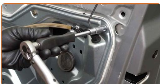
**54** Collegare il cablaggio dell'alzacristalli elettrico.
