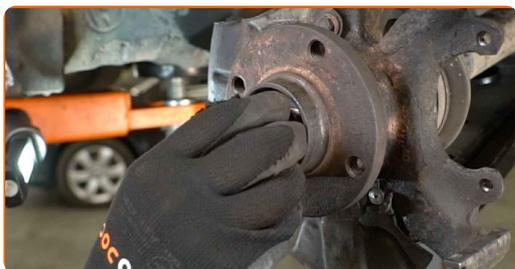
**59** Avvita gli elementi di fissaggio del giunto sferico. Utilizza una chiave a bussola N°13. Usa una chiave a cricchetto.
