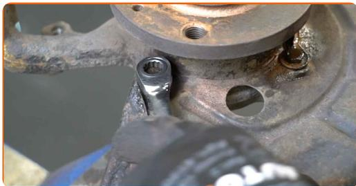
**31** Rimuovi la lamiera di protezione del disco freno.
