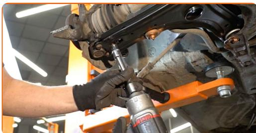
**60** Pulisci le sedi di montaggio delle testine tiranti dello sterzo. Usa una spazzola metallica. Usa lo spray WD-40.
