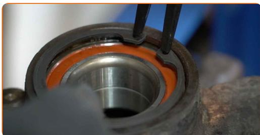
**44** Pulire la sede di montaggio del mozzo della ruota. Usa lo spray WD-40.
