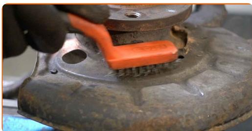
**30** Svita gli elementi di fissaggio della lamiera di protezione del disco freno. Utilizza una chiave combinata N°10.
