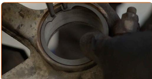
**42** Inserire il nuovo cuscinetto nel fuso a snodo. Usare un set di montaggio/smontaggio cuscinetti e boccole.
