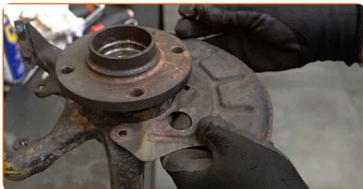
**49** Avvita gli elementi di fissaggio della lamiera di protezione del disco freno. Utilizza una chiave combinata N°10.
