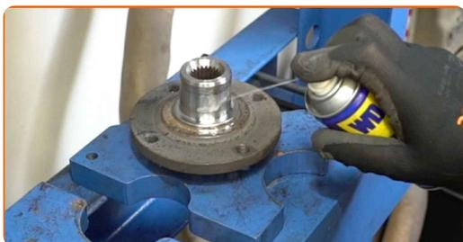
**45** Installare il mozzo della ruota sul fuso a snodo. Usare un set di montaggio/smontaggio cuscinetti e boccole.
