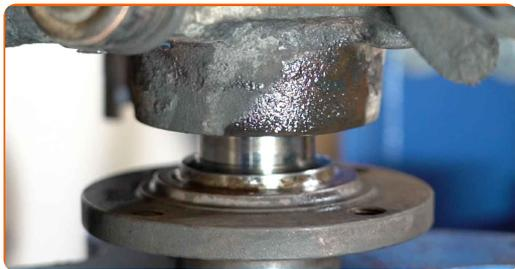
**46** Posizionare il fuso a snodo con il mozzo della ruota in una morsa.
