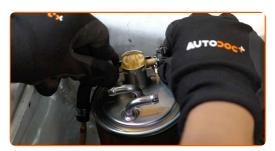
13 Installare la clip di fissaggio del tubo del carburante.
