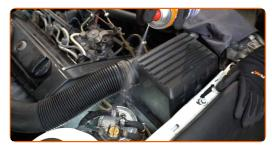
Allentare l'elemento di montaggio del filtro del combustibile. Utilizza una chiave a bussola N°13. Usa una chiave a cricchetto.
