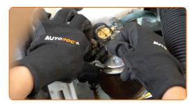
Avvita gli elementi di fissaggio che collegano il tubo di rifornimento carburante alla scatola del filtro carburante. Utilizza una chiave a bussola N°7. Usa una chiave a cricchetto.
