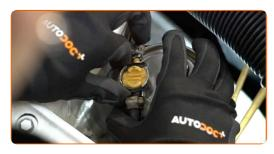
14 Installare il tubo del carburante.
