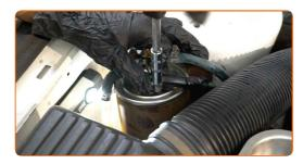
Avvitare la staffa di montaggio del filtro carburante. Utilizza una chiave a bussola N°13. Usa una chiave a cricchetto.
