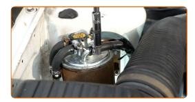
Scollegare le linee di alimentazione del carburante dal filtro del carburante. Usa delle pinze a becchi lunghi.
