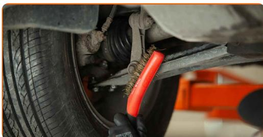
**3** Svita gli elementi di fissaggio che collegano il tirante della barra stabilizzatrice al braccio di sospensione. Utilizza una chiave combinata N°16. Usa una chiave dinamometrica.
