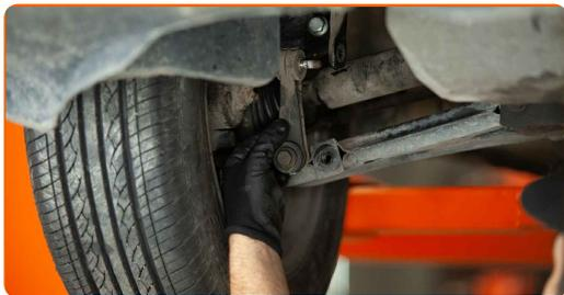
**5** Pulisci i giunti della barra stabilizzatrice. Usa una spazzola metallica. Tratta con del prodotto tutti i giunti della barra stabilizzatrice. Usa lo spray WD-40.
