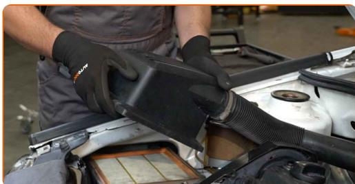
**8** Svitare gli elementi di fissaggio dell'alloggiamento del gruppo di distribuzione dell'aria. Utilizza una chiave a bussola N°7. Usa una chiave a cricchetto.
