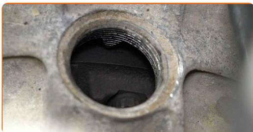
**83** Ruotare l'ingranaggio dell'albero a gomiti. Usa la chiave a bussola 12 punte n.19. Usa una chiave a cricchetto.
