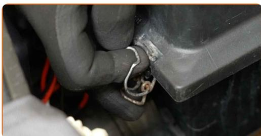
**114** Avvitare i dispositivi di fissaggio dell'alloggiamento del gruppo di distribuzione dell'aria. Utilizza una chiave a bussola N°7. Usa una chiave a cricchetto.
