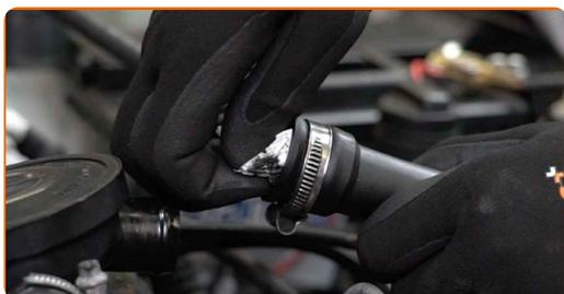
**91** Installa il tubo flessibile del sistema di ventilazione del basamento.
