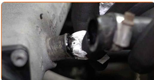
**93** Installa il tubo flessibile del sistema di ventilazione del basamento.
