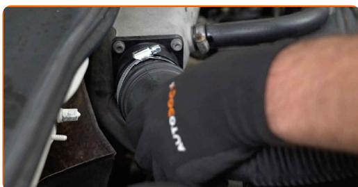
**112** Montare il coperchio del filtro d'aria. Fissarlo.
