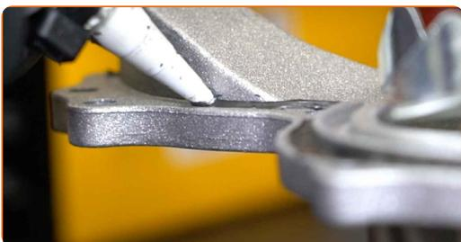
**66** Installare la guarnizione della pompa dell'acqua.
