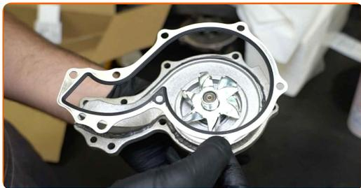
**67** Installare la nuova pompa dell'acqua.
