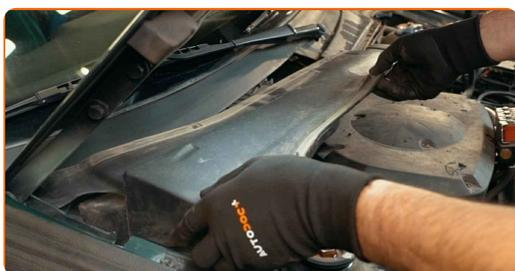
**15** Installa la guarnizione griglia sottoparabrezza.
