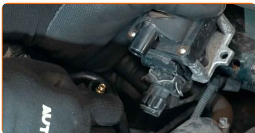
Sostituzione: bobina d'accensione - VW GOLF III Variant (1H5). AUTODOC raccomanda:
