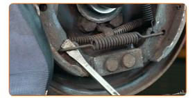
Rimuovere gli elementi di fissaggio delle ganasce del freno a tamburo. Utilizzare un compressore per molla di ritenzione della ganascia del freno.
