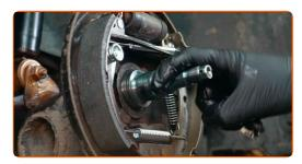
Monta il freno a tamburo assemblato con il cuscinetto del mozzo ruota.
