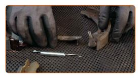
Installare la leva di regolazione della ganascia del freno.
