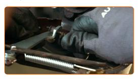
Installare le ganasce del freno sul cilindretto apriceppi e sulla staffa del supporto.
