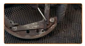
Rimuovere la leva di regolazione della ganascia del freno.
