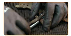
Monta le molle di arresto superiori e il meccanismo di regolazione sulle nuove ganasce del freno. Usa un giravite piatto.
