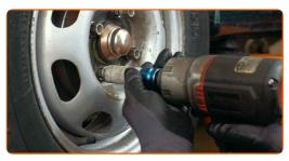
Regolare la tensione del cavo del freno di stazionamento. Utilizza una chiave combinata N°10.
