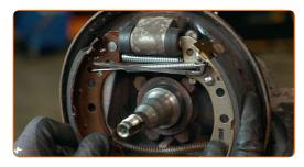
Installare gli elementi di fissaggio delle ganasce del freno a tamburo. Utilizzare un compressore per molla di ritenzione della ganascia del freno.
