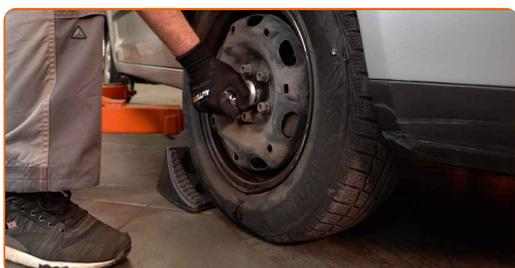
7 Allentare i bulloni di fissaggio della ruota. Usa la chiave a bussola per dadi cerchio ruota n.17.
