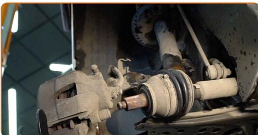
25 Svitare il perno di fissaggio superiore del supporto di ammortizzazione.
