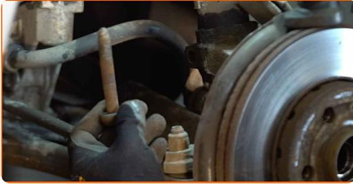
23 Sgancia gli elementi di fissaggio che collegano il puntone dell'ammortizzatore al fuso a snodo. Usa una chiave a bussola specifica per rimuovere l'ammortizzatore. Usa una chiave a cricchetto.
