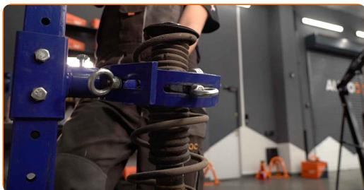
**38** Rimuovi il parapolvere e il paracolpi dell'ammortizzatore.
