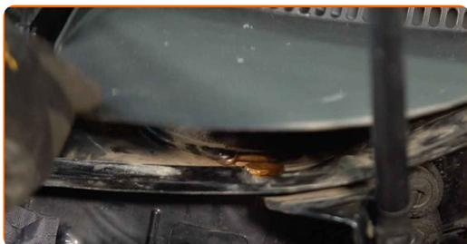
**74** Installa la guarnizione griglia sottoparabrezza.
