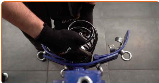
**43** Installare il parapolvere e il limitatore flessione dinamica sul nuovo ammortizzatore.
