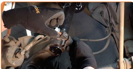
**54** Serra gli elementi di fissaggio inferiori che collegano l'ammortizzatore al fuso a snodo. Utilizza una chiave a bussola N°18. Usa la chiave XZN n.12. Usa una chiave a cricchetto.
