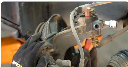
**52** Fissare il supporto di ammortizzazione sul fuso a snodo.
