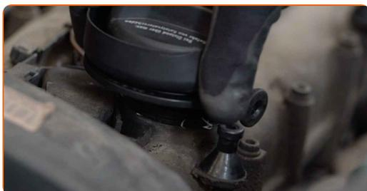
20 Collega il tubo di ventilazione del carter motore al bocchettone di riempimento dell'olio.
