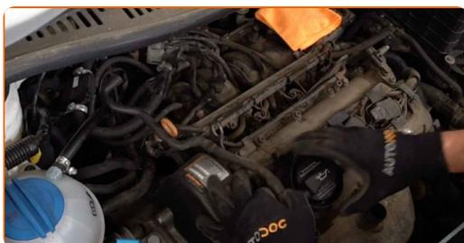
7 Svita il bocchettone di riempimento dell'olio. Rimuovi il bocchettone di riempimento dell'olio.
