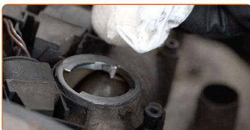
19 Installa il bocchettone di riempimento dell'olio. Avvita il bocchettone di riempimento dell'olio.
