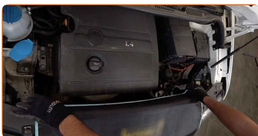
3 Scollega il tubo di ventilazione del carter motore dal coperchio del motore a sinistra.
