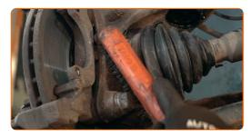
Svitare l'attacco della staffa pinza freno. Utilizza una chiave a bussola N°21. Usa una chiave a cricchetto. Usa un giramaschi.
