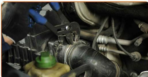
**5** Scollega il tubo di aspirazione dell'aria dall'alloggiamento del filtro dell'aria.
