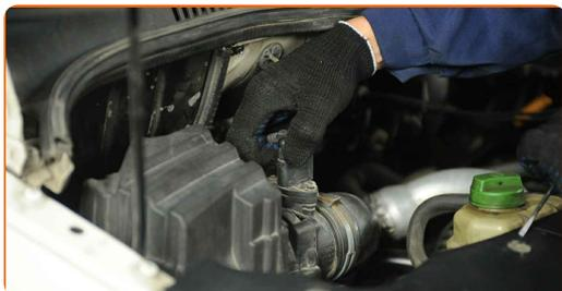
**4** Scollega il collare di fissaggio del tubo di aspirazione. Usa le pinze per fascette Clic-R.
