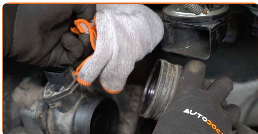
**13** Montare il coperchio del filtro d'aria. Fissarlo.
