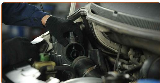
**8** Rimuovere dall'alloggiamento del filtro l'elemento filtrante da sostituire.
