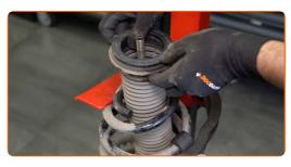
Sostituzione: supporto ammortizzatore - VW California T5 Bus (7EC, 7EF, 7EG, 7HF). AUTODOC raccomanda:
