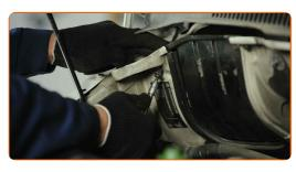
61 Installa la guarnizione griglia sottoparabrezza.
