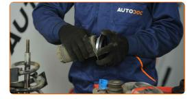
Installare un nuovo elemento di montaggio del supporto di ammortizzazione superiore.
