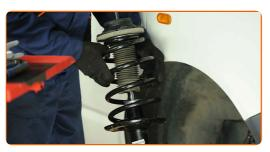
Avvitare i fissaggi superiori del supporto del puntone di sospensione.
