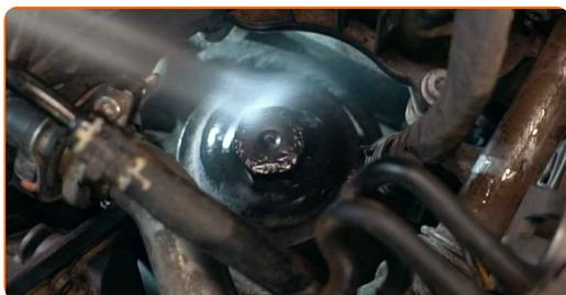
**7** Svitare il tappo dell'alloggiamento del filtro insieme al vecchio elemento filtrante. Utilizza una chiave a bussola N°30. Usa una chiave a cricchetto.
