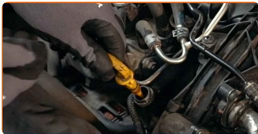
**6** Pulisci il tappo dell'alloggiamento del filtro dell'olio. Usa un detergente spray multiuso.
