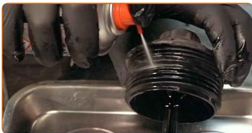
**18** Installa i nuovi o-ring e il nuovo filtro dell'olio alle loro sedi di montaggio sul coperchio del filtro.
