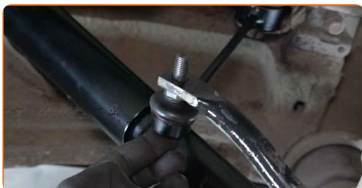
**14** Serra gli elementi di fissaggio del tirante della barra stabilizzatrice. Utilizza una chiave combinata N°17. Utilizza una chiave a bussola N°19. Usa una chiave a cricchetto.
