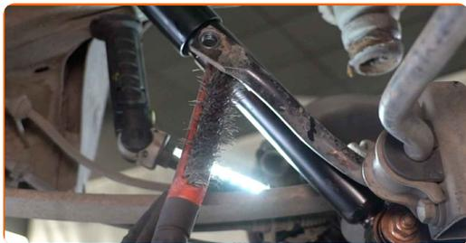
**12** Installa il puntone stabilizzatore trasversale.
