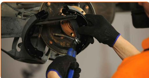
**20** Installare le ganasce del freno sul cilindretto apriceppi e sulla staffa del supporto.
