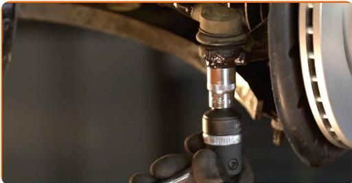
8 Misura e memorizza la posizione precisa del giunto sferico sulla barra di accoppiamento, oppure conta il numero di giri completi al fine di evitare il disallineamento durante il montaggio successivo. Usa un calibro a corsoio.
