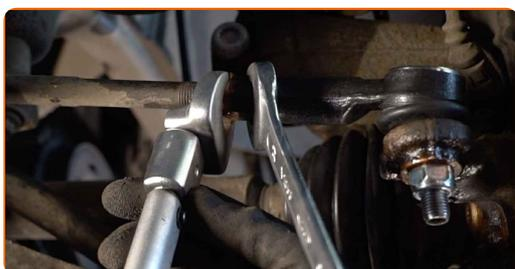
18 Tratta con del prodotto l'elemento di fissaggio che collega la testina tirante al fuso a snodo. Usa il grasso al rame.
