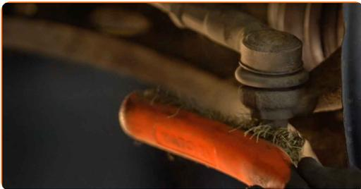
7 Svitare il dado di attacco del gambo al fuso a snodo. Utilizza una chiave a bussola N°18. Usa un giramaschi.
