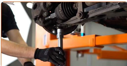
**17** Svita gli elementi di fissaggio che collegano il puntone dell'ammortizzatore al fuso a snodo. Utilizza una chiave combinata N°18. Utilizza una chiave a bussola N°18.
