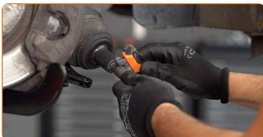
**39** Tratta la sede di montaggio del puntone dell'ammortizzatore sul fuso a snodo. Usa lo spray WD-40.
