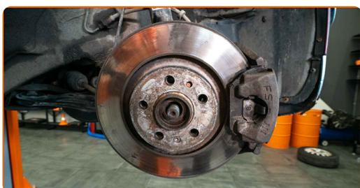
**12** Pulisci gli elementi di fissaggio che collegano il puntone dell'ammortizzatore al fuso a snodo. Pulisci gli elementi di fissaggio che collegano il giunto sferico al braccio di controllo della sospensione. Usa una spazzola metallica. Usa lo spray WD-40.
