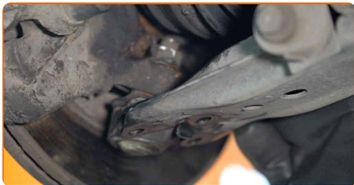
**45** Avvita gli elementi di fissaggio della piastra di serraggio per snodo sferico. Importante! Assicurarsi di utilizzare elementi di fissaggio nuovi. Utilizza una chiave a bussola N°13. Usa una chiave dinamometrica. Serralo fino allo coppia di torsione di 20 Nm. +90°
