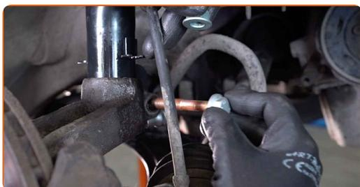
**42** Rimuovi il supporto da sotto il fuso a snodo.
