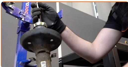
Sostituzione: ammortizzatore a molla - VW Bora Variant (1J6). Gli esperti di AUTODOC raccomandano:
