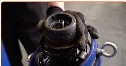
**39** Serrare la vite dell'asta pistone supporto ammortizzazione. Utilizza una chiave a bussola N°21. Usa una chiave HEX N.H7. Usa una chiave dinamometrica. Serralo fino allo coppia di torsione di 60 Nm.
