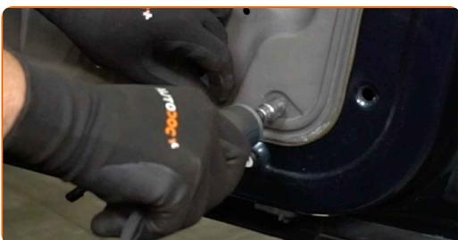
**22** Stringere le clip e staccare il meccanismo di azionamento del finestrino. Usa delle pinze a becchi lunghi.
