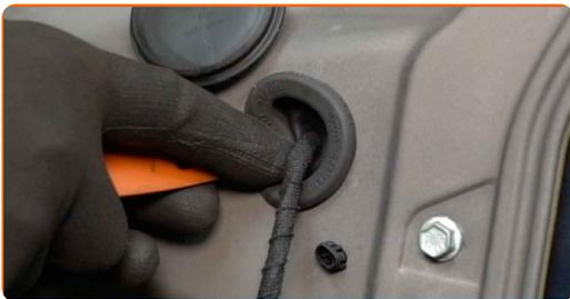
**20** Rimuovere le clip di fissaggio del pannello della portiera. Usa un giravite piatto.
