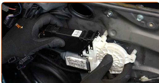
**40** Stringere gli elementi di fissaggio del motorino dell'alzacristalli. Usa la chiave Torx T 30. Usa una chiave dinamometrica. Serralo fino allo coppia di torsione di 4 Nm.
