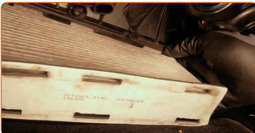
Sostituzione: filtro antipolline - VW Beetle Hatchback (5C1, 5C2). Il consiglio degli esperti di AUTODOC:
