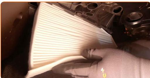
Sostituzione: filtro antipolline - VW Beetle Hatchback (5C1, 5C2). Gli esperti di AUTODOC raccomandano:
