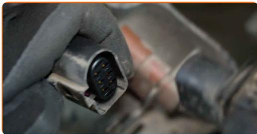
**7** Svitare l'elemento di fissaggio del sensore di ossigeno. Utilizzare una presa per sensore di ossigeno da 22 mm. Usa una chiave a cricchetto.
