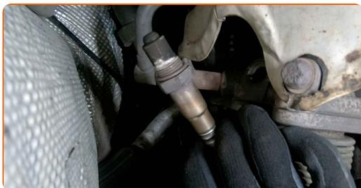
**9** Tagliare il filo per il nuovo sensore di ossigeno. Utilizzare un maschio per filettatura. Usa una chiave a cricchetto.
