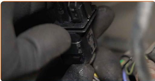
**15** Installare il coperchio dell'alloggiamento della sonda lambda.
