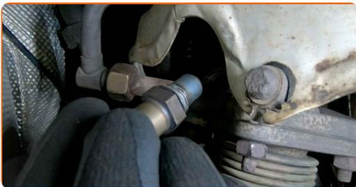
**12** Stringere l'elemento di fissaggio del sensore di ossigeno. Utilizzare una presa per sensore di ossigeno da 22 mm. Usa una chiave dinamometrica. Serralo fino allo coppia di torsione di 37 Nm.
