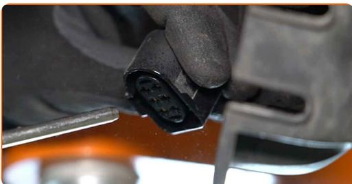
**14** Collegare il connettore del sensore di ossigeno.
