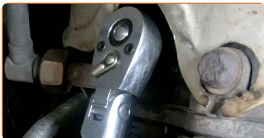
**10** Applicare un prodotto trattante sul sensore di ossigeno. Utilizzare grasso ceramico per alte temperature.
