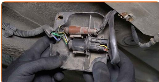
**6** Scollegare il connettore del sensore di ossigeno.
