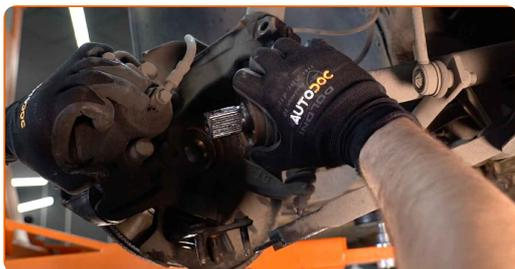
**26** Puntellare il fuso a snodo. Usa un cric idraulico per trasmissione.
