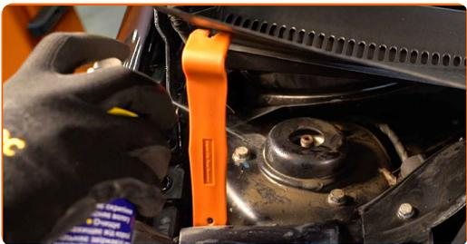
**6** Allenta gli elementi di fissaggio superiori del supporto dell'ammortizzatore. Utilizza una chiave a bussola N°13. Usa una chiave a cricchetto.
