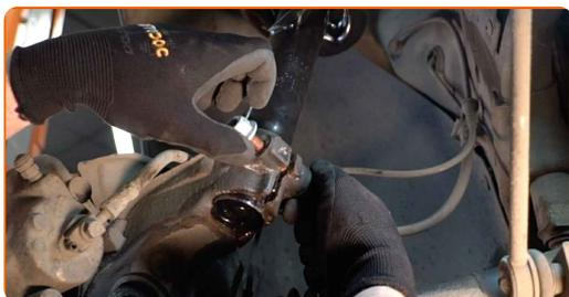
**52** Serra gli elementi di fissaggio inferiori che collegano l'ammortizzatore al fuso a snodo. Utilizza una chiave a bussola N°18. Usa la chiave XZN n.12. Usa una chiave a cricchetto.
