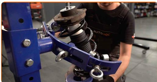
**47** Installare il supporto di ammortizzazione nell'arco passaruota.
