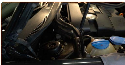
**5** Pulisci gli elementi di fissaggio del supporto superiore del puntone dell'ammortizzatore. Usa lo spray WD-40.
