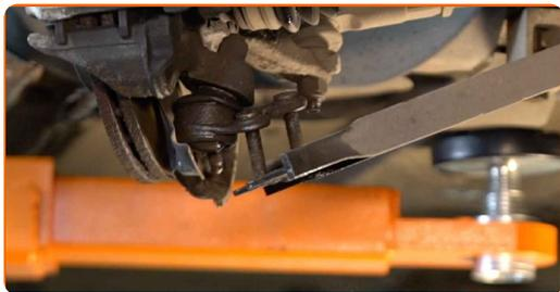
**23** Svita gli elementi di fissaggio che collegano l'albero di trasmissione al mozzo della ruota. Utilizza una chiave a bussola N°27.
