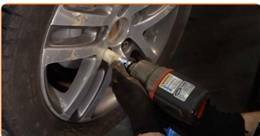
**41** Rimettere il veicolo per terra e, lavorando in ordine incrociato, serrare i bulloni di fissaggio delle ruote. Usa una chiave dinamometrica. Serralo fino allo coppia di torsione di 120 Nm.
