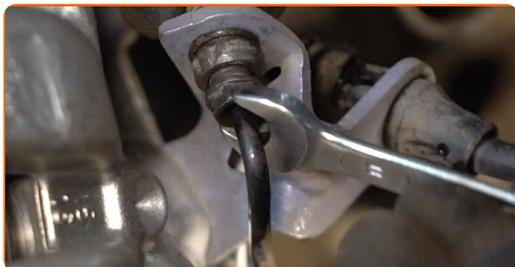
**27** Tratta con del prodotto il tubo flessibile del freno. Tratta con del prodotto il tubo del freno. Usa un pulitore freni.
