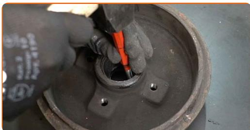
**13** Installare la nuova pista interna del cuscinetto della ruota dal tamburo del freno. Usare un set di montaggio/smontaggio cuscinetti e boccole. Usa un martello.
