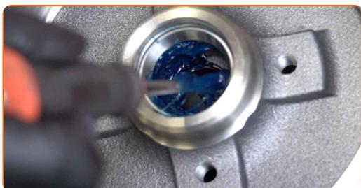
**15** Installare un nuovo cuscinetto del mozzo della ruota e fissarlo.
