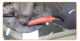
Svita gli elementi di fissaggio che collegano il giunto sferico al braccio di sospensione. Utilizza una chiave a bussola N°21. Usa una chiave a cricchetto.
