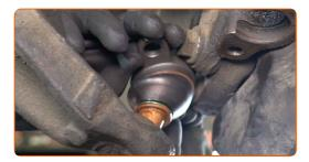
Collega il giunto sferico al fuso a snodo. Usa un piede di porco. Usa un martello di gomma.
