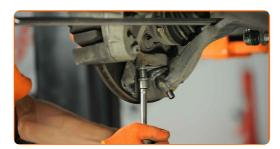
Stringere gli elementi di fissaggio che collegano il giunto sferico al braccio di controllo. Utilizza una chiave a bussola N°21. Usa una chiave dinamometrica. Serralo fino allo coppia di torsione di 100 Nm.
