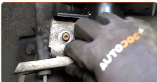
**66** Avvitare l'elemento di fissaggio che collega la bielletta della barra antirollio al puntone di sospensione. Utilizza una chiave a bussola N°15. Usa una chiave a cricchetto.
