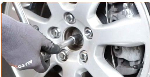
**9** Allentare i bulloni delle ruote. Usa la chiave a bussola per dadi cerchio ruota n.19. Usa un giramaschi.
