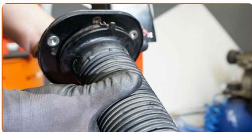
**47** Installare il montante superiore del puntone insieme al bump stop (fine corsa).
