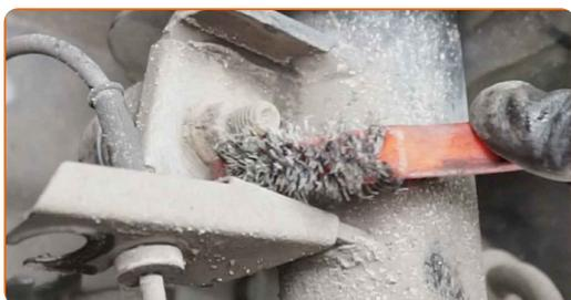
**16** Svita gli elementi di fissaggio che collegano il tirante della barra stabilizzatrice al puntone dell'ammortizzatore. Utilizza una chiave a bussola N°15. Usa una chiave a cricchetto.
