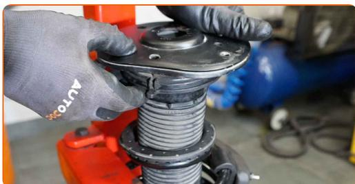
**48** Stringere il dado dell'asta del pistone del puntone di sospensione. Utilizzare un dado a risvolto da 18 mm. Usa una chiave HEX N.H6. Usa una chiave dinamometrica. Serralo fino allo coppia di torsione di 50 Nm.
