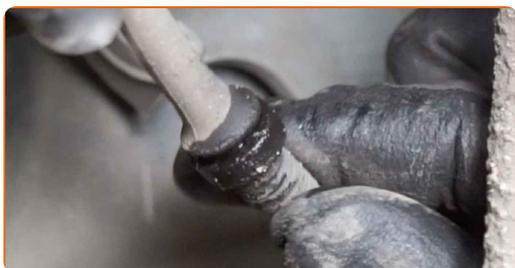
**15** Pulire l'elemento di fissaggio che collega la bielletta della barra antirollio al puntone di sospensione. Usa una spazzola metallica. Usa lo spray WD-40.
