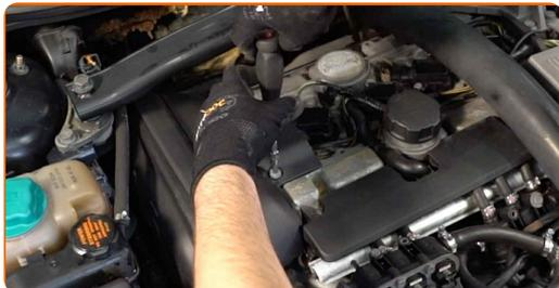
**4** Rimuovere la copertura del motore.
