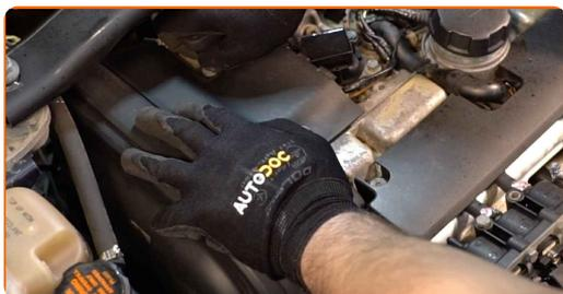
28 Avvita gli elementi di fissaggio del coperchio del motore. Usa la chiave Torx T 20. Usa una chiave a cricchetto.
