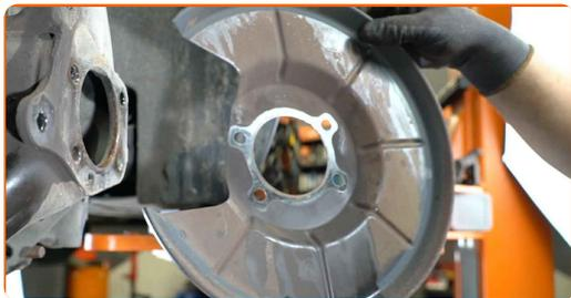
**29** Pulire la sede di montaggio del mozzo della ruota. Usa una spazzola metallica.
