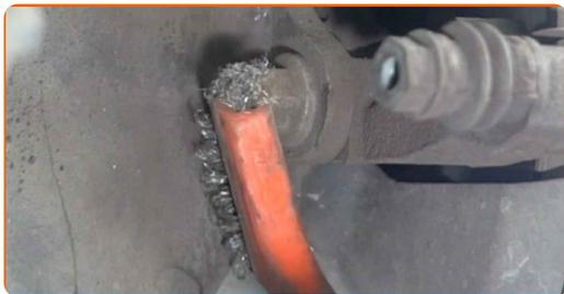
**12** Svitare gli elementi di fissaggio del supporto della pinza del freno. Utilizza una chiave a bussola N°15. Usa una chiave a cricchetto.
