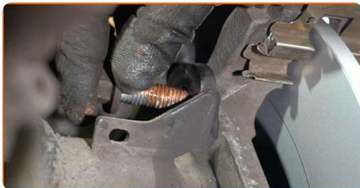
**45** Serrare gli elementi di fissaggio del supporto della pinza del freno. Utilizza una chiave a bussola N°15. Usa una chiave dinamometrica. Serralo fino allo coppia di torsione di 110 Nm.
