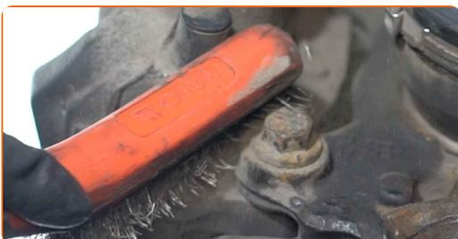
**12** Svitare gli elementi di fissaggio del supporto della pinza del freno. Utilizza una chiave a bussola N°18. Usa una chiave a cricchetto.
