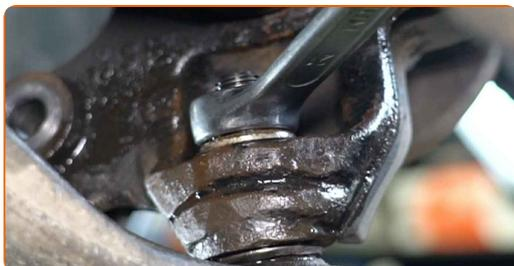
**38** Separare il giunto sferico dal fuso a snodo dello sterzo. Usa un estrattore del giunto sferico. Usa un piede di porco.
