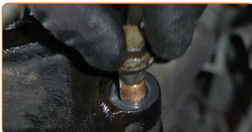
**36** Pulisci l'elemento di fissaggio che collega il giunto sferico al fuso a snodo. Usa una spazzola metallica. Usa lo spray WD-40.
