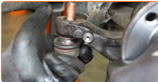
**63** Avvita il dado di serraggio che collega le testine tiranti dello sterzo al fuso a snodo. Utilizza una chiave a bussola N°22. Usa una chiave a cricchetto.
