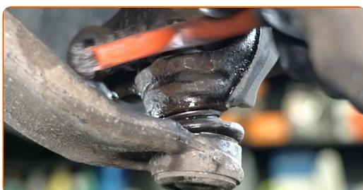
**37** Svitare l'elemento di fissaggio che collega il giunto sferico al fuso a snodo dello sterzo. Utilizza una chiave combinata N°21.
