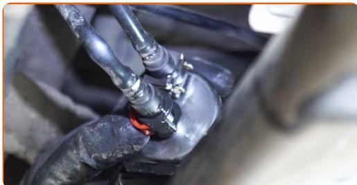
**13** Avvitare la staffa di montaggio del filtro carburante. Usa la chiave Torx T30. Usa una chiave a cricchetto.
