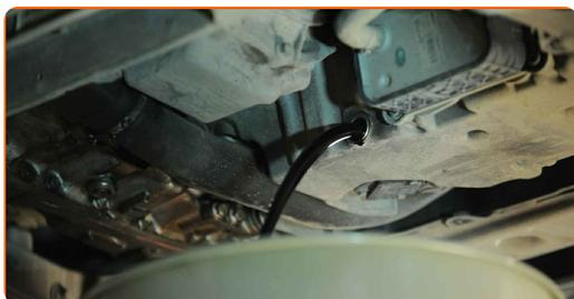
Sostituzione: olio motore e filtro - VOLVO S80 II (AS, 124). Consiglio:
