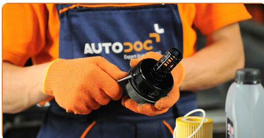
17 Installa il nuovo coperchio O-ring sulla sua sede di montaggio sul coperchio del filtro. Usa un giravite piatto.
