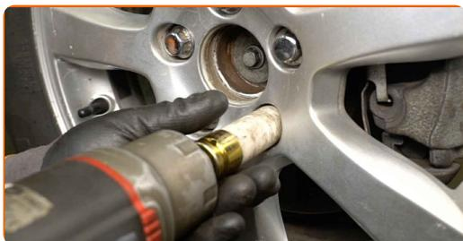
**27** Rimettere il veicolo per terra e, lavorando in ordine incrociato, serrare i bulloni di fissaggio delle ruote. Usa la chiave a bussola per dadi cerchio ruota n.19. Usa una chiave dinamometrica. Serralo fino allo coppia di torsione di 140 Nm.
