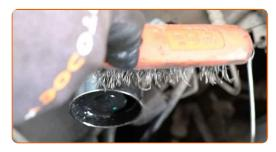
Pulire l'elemento di fissaggio che collega la bielletta della barra antirollio al puntone di sospensione. Usa una spazzola metallica.
