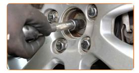
Allentare i bulloni delle ruote. Usa la chiave a bussola per dadi cerchio ruota n.19. Usa un giramaschi.
