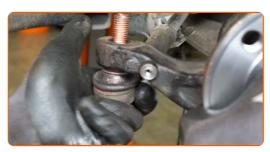
Avvita il dado di serraggio che collega le testine tiranti dello sterzo al fuso a snodo. Utilizza una chiave a bussola N°22. Usa una chiave a cricchetto.
