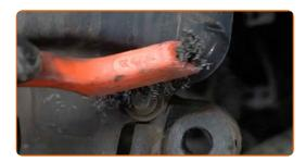
Svita gli elementi di fissaggio della lamiera di protezione del disco freno. Utilizza una chiave a bussola N°8. Usa una chiave a cricchetto.
