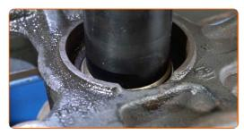
Pulisci la sede di montaggio del cuscinetto del mozzo. Usa una spazzola metallica. Usa lo spray WD-40.
