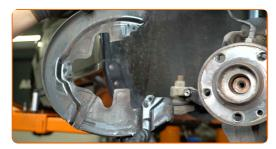
Pulisci il connettore del sensore di velocità ABS. Usare una spazzola pulente in nylon. Usa un detergente spray multiuso.
