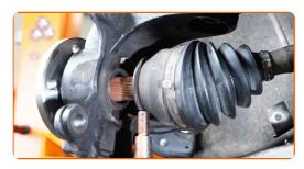
Collegare il giunto sferico al fuso a snodo dello sterzo. Usa un piede di porco.
