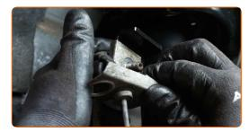
Avvitare l'elemento di fissaggio che collega la bielletta della barra antirollio al puntone di sospensione. Utilizza una chiave a bussola N°15. Usa una chiave a cricchetto.
