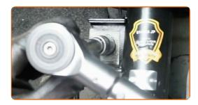
Serra il bullone di fissaggio che collega la testina tirante al fuso a snodo. Utilizza una chiave a bussola N°22. Usa una chiave dinamometrica. Serralo fino allo coppia di torsione di 80 Nm.
