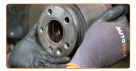
Svita gli elementi di fissaggio che collegano l'albero di trasmissione al mozzo della ruota. Utilizza una chiave a bussola N°13. Usa una chiave a cricchetto.
