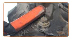
Svitare gli elementi di fissaggio del supporto della pinza del freno. Utilizza una chiave a bussola N°18. Usa una chiave a cricchetto.
