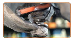
Svitare l'elemento di fissaggio che collega il giunto sferico al fuso a snodo dello sterzo. Utilizza una chiave combinata N°21.
