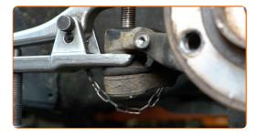
Pulire l'elemento di fissaggio inferiore che collega il puntone di sospensione al fuso a snodo dello sterzo. Usa una spazzola metallica. Usa lo spray WD-40.
