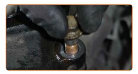
Pulisci l'elemento di fissaggio che collega il giunto sferico al fuso a snodo. Usa una spazzola metallica. Usa lo spray WD-40.
