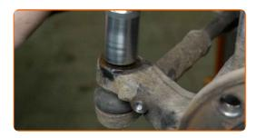
Separare l'estremità del tirante dal fuso a snodo dello sterzo. Usa un estrattore del giunto sferico.
