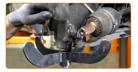
Sgancia gli elementi di fissaggio che collegano il puntone dell'ammortizzatore al fuso a snodo. Usa uno scalpello piatto per la lavorazione dei metalli. Usa un martello.
