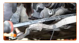
Avvita gli elementi di fissaggio che collegano il giunto sferico al fuso a snodo. Utilizza una chiave combinata N°21.
