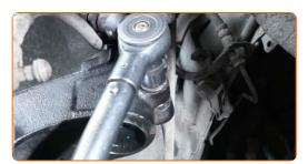
Serrare gli elementi di fissaggio del supporto della pinza del freno. Utilizza una chiave a bussola N°18. Usa una chiave dinamometrica. Serralo fino allo coppia di torsione di 150 Nm.
