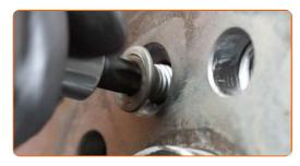
Stringere gli elementi di fissaggio del disco del freno. Usa la chiave Torx T50. Usa una chiave dinamometrica. Serralo fino allo coppia di torsione di 15 Nm.
