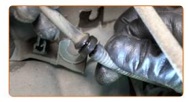
Svita gli elementi di fissaggio che collegano il tirante della barra stabilizzatrice al puntone dell'ammortizzatore. Utilizza una chiave a bussola N°15. Usa una chiave a cricchetto.
