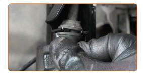
Serrare i fermi inferiori del puntone di sospensione. Utilizza una chiave a bussola N°15. Usa una chiave dinamometrica. Serralo fino allo coppia di torsione di 110 Nm.
