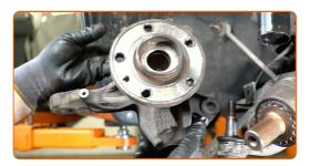
Pulire la sede di montaggio del puntone di sospensione sul fuso a snodo dello sterzo. Usa una spazzola metallica.
