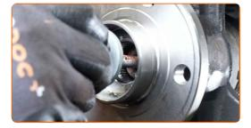
Avvitare l'elemento di fissaggio del semiasse. Utilizza una chiave a bussola N°13. Usa una chiave a cricchetto.
