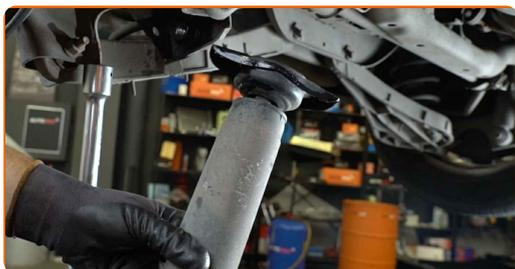
**14** Pulisci le sedi di montaggio dell'ammortizzatore. Usa una spazzola metallica.
