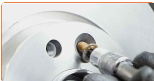
**26** Stringere gli elementi di fissaggio del disco del freno. Usa la chiave Torx T50. Usa una chiave dinamometrica. Serralo fino allo coppia di torsione di 15 Nm.
