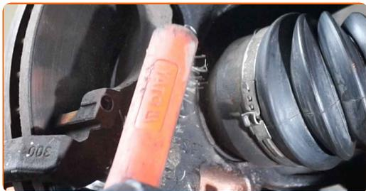
**15** Svitare gli elementi di fissaggio del supporto della pinza del freno. Utilizza una chiave a bussola N°18. Usa una chiave a cricchetto.
