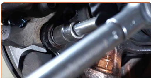
**37** Installare i tappi sui perni di guida delle pinze dei freni.
