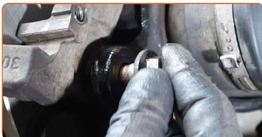
**30** Serrare gli elementi di fissaggio del supporto della pinza del freno. Utilizza una chiave a bussola N°18. Usa una chiave dinamometrica. Serralo fino allo coppia di torsione di 150 Nm.
