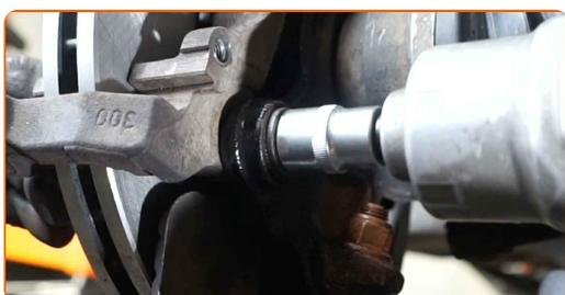
**31** Tratta con del prodotto il pistone della pinza freno. Usare una spazzola pulente in nylon. Usa un pulitore freni.
