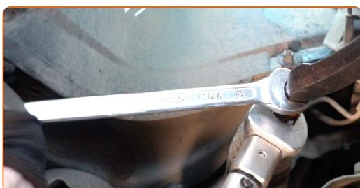
**18** Serra il bullone di fissaggio che collega la testina tirante al fuso a snodo. Utilizza una chiave a bussola N°18. Usa una chiave dinamometrica. Serralo fino allo coppia di torsione di 65 Nm.
