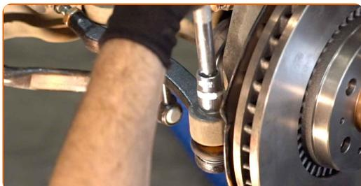
**19** Misura e memorizza la posizione precisa del giunto sferico sulla barra di accoppiamento, oppure conta il numero di giri completi al fine di evitare il disallineamento durante il montaggio successivo. Usa un calibro a corsoio.
