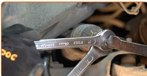
**17** Serrare il controdado del gambo. Utilizza una chiave combinata N°19. Utilizza una chiave combinata N°22. Usa una chiave dinamometrica. Serralo fino allo coppia di torsione di 70 Nm.
