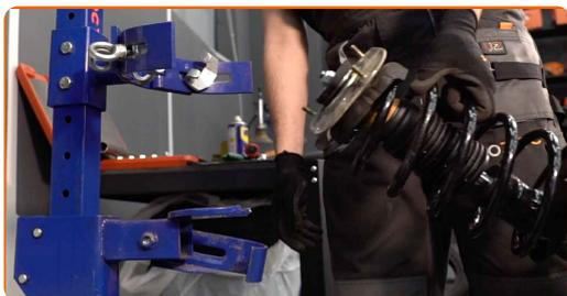
**38** Installare il supporto di ammortizzazione nell'arco passaruota.
