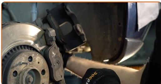
Sostituzione: dischi freni - VOLVO S60 I (384). AUTODOC raccomanda:
