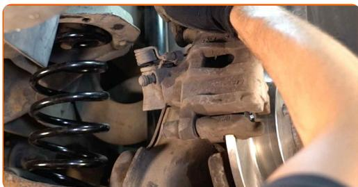
**27** Installare la molla di fissaggio della pinza freno. Usa un martello di gomma.
