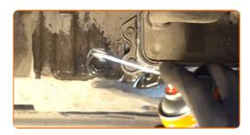
Poni un contenitore per gli oli esausti di una capacità di almeno 5 litri al di sotto del foro di drenaggio.
