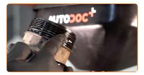
Avvitare il nuovo filtro nella posizione di lavoro. Usa la bussola 86/14-F. Usa una chiave dinamometrica. Serralo fino alla coppia di torsione di 25 Nm.
