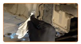
Avvita il nuovo tappo di drenaggio e stringerlo. Utilizza una chiave a bussola N°15. Usa una chiave dinamometrica. Serralo fino alla coppia di torsione di 38 Nm.
