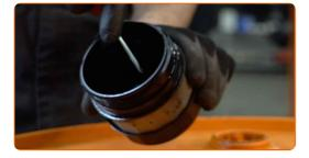
Installa il nuovo coperchio O-ring sulla sua sede di montaggio sul coperchio del filtro.
