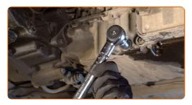
Pulisci la zona del foro di drenaggio della coppa dell'olio. Usa un detergente spray multiuso.
