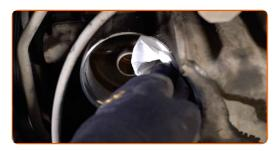
Installa il nuovo filtro dell'olio alla sede di montaggio del coperchio del filtro.
