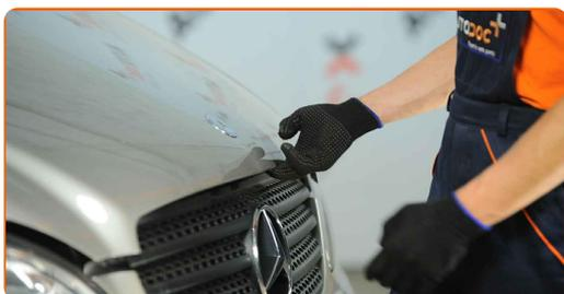
**2** Usa una copertura di protezione del parafranco per evitare il danneggiamento della verniciatura e dei componenti in plastica dell'auto.
