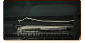
Rimuovi la griglia sottoparabrezza di plastica inferiore.
