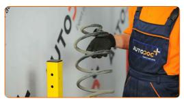
Rimuovi l'ammortizzatore vecchio dal compressore idraulico per molle ammortizzatori.
