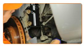
Collega gli elementi di fissaggio del cavo sensore ABS ai supporti di ammortizzazione. Collegare il fissaggio del cavo del sensore di usura delle pastiglie del freno al puntone di sospensione.
