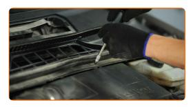
Installa la griglia del sottoparabrezza e fissala.
