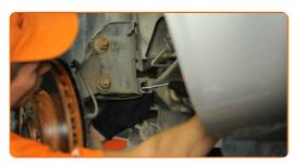
Scollegare il cablaggio del sensore ABS. Staccare il fissaggio del cavo del sensore di usura delle pastiglie del freno dal puntone di sospensione. Usa un giravite piatto.
