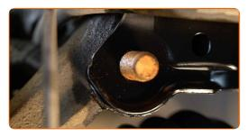
Serra gli elementi di fissaggio inferiori che collegano l'ammortizzatore al fuso a snodo. Utilizza una chiave combinata N°21. Utilizza una chiave a bussola N°21. Usa una chiave dinamometrica. Serralo fino allo coppia di torsione di 120 Nm. +75°
