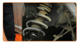
Avvita l'elemento di fissaggio superiore del montante supporto ammortizzazione.
