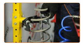
Installare il supporto, il soffietto parapolvere ed il bump stop (fine corsa) su un nuovo ammortizzatore.
