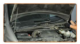
Svita gli elementi di fissaggio del pannello della tiranteria del tergicristallo. Utilizza una chiave a bussola N°13. Usa una chiave a cricchetto.
