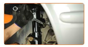
Fissare sul montante il tubo dell'impianto freni. Usa un giravite piatto.
