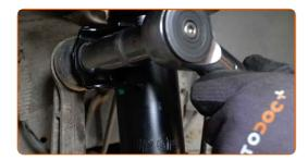
Tratta con del prodotto gli elementi di fissaggio del supporto del puntone dell'ammortizzatore. Tratta con del prodotto gli elementi di fissaggio del fuso a snodo. Usa il grasso al rame.
