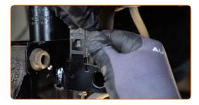
Fissare sul montante il tubo dell'impianto freni.
