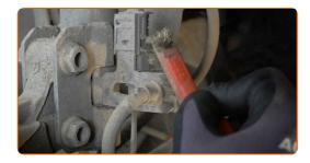
Rimuovi gli elementi di fissaggio collegati al tubo flessibile del freno all'ammortizzatore. Usa delle pinze.
