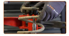
Rimuovi l'ammortizzatore vecchio dal compressore idraulico per molle ammortizzatori.
