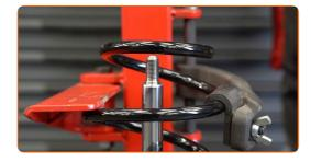
Installare il supporto, il parapolvere e il paracolpi sul nuovo ammortizzatore.
