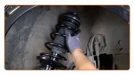
Fissare il supporto di ammortizzazione sul fuso a snodo.
