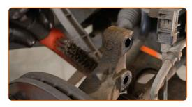
Installare il supporto di ammortizzazione nell'arco passaruota.
