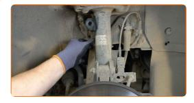
Pulisci gli elementi di fissaggio che collegano il tubo flessibile del freno al puntone dell'ammortizzatore. Usa una spazzola metallica. Usa lo spray WD-40.
