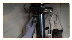
Serra gli elementi di fissaggio che collegano il tirante della barra stabilizzatrice al puntone dell'ammortizzatore. Utilizza una chiave combinata N°17. Utilizza una chiave a bussola N°18. Usa una chiave dinamometrica. Serralo fino allo coppia di torsione di 55 Nm.
