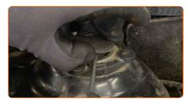
Rimuovi il fermo di arresto del supporto superiore del puntone dell'ammortizzatore. Usa un giravite piatto.
