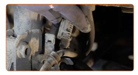
Pulisci gli elementi di fissaggio che collegano il puntone dell'ammortizzatore al fuso a snodo. Usa una spazzola metallica. Usa lo spray WD-40.
