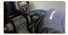
Installa la clip di fissaggio del tubo flessibile del freno. Usa un martello.
